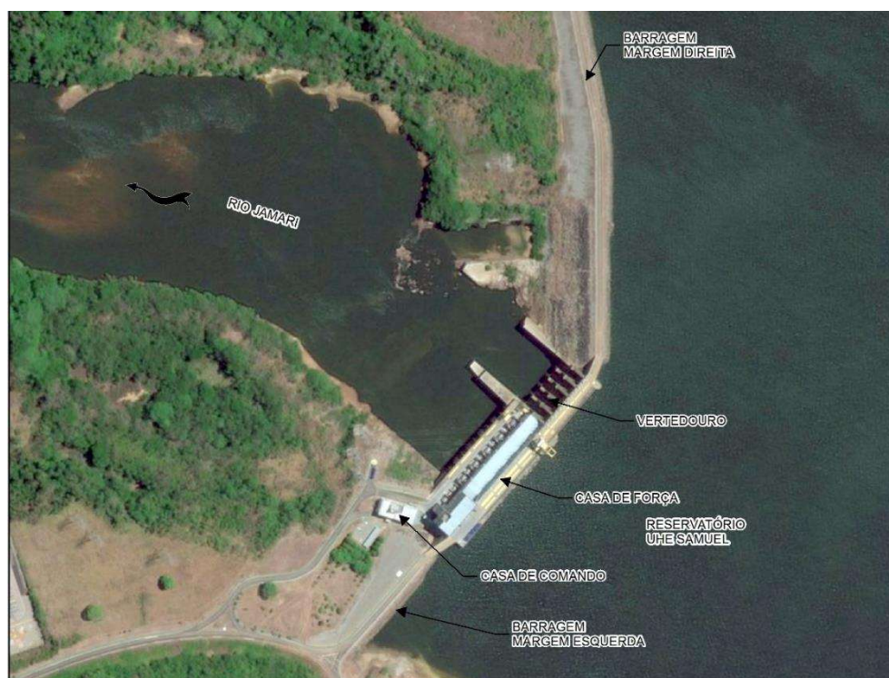
Figura 1.2: UHE Samuel – Ortoimagem da Barragem, Casa de Força e Vertedouro
